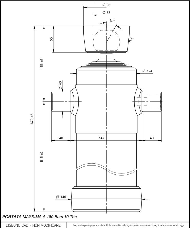
Descrizione / Description: **DISEGNO** Di Natale costruzione **3360S** cilindri - Bertelli spA Cil. Telescopico 4x1990x124 Sfera Ø55 telescopici CODICE Via S. Pietro 76 Roè Volciano (BRESCIA) ITALY Press. Max. Bars: 180 Corsa/Stroke mm: 1990 3049S Modifiche Lunghezza/lenght mm: 570 Olio/Oil Lt.: 11 50,0 kg DATA 01/12/09 DATA 01/12/09 Trattamento/Treatment : tenifer SCALA 1:2 DISEGNATO : APPROVATO: Diametro sfilate: Massimo Di Natale 61-76-91-107
